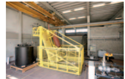
⌘ Proefopstelling voor het testen en keuren van UF 6 -containers.
