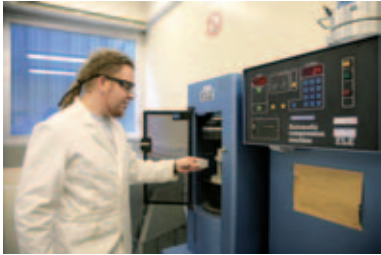
⤴ Uitvoeren van een druksterkteproef op een betonmonster.
