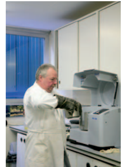
⤴ Vergruizen van betongranulaten in een kogelmolen.
